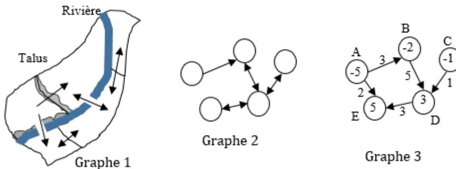
Par exemple, sur cette zone à niveler (graphe 1), traversée par une rivière et un talus, les flèches représentent les communications entre les cinq cellules qui sont le résultat d'une discrétisation du terrain (voir graphe 2).
