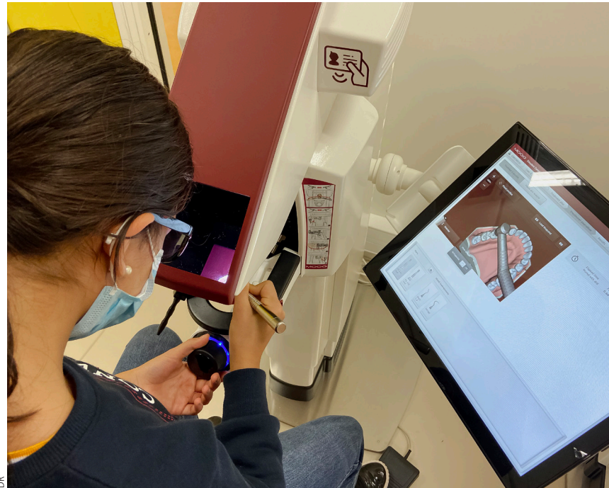
Le simulateur haptique à l'Université de Lorraine permet de s'exercer sans risques et sans consommables aux actes techniques de chirurgie dentaire: un jeu d'enfant.
