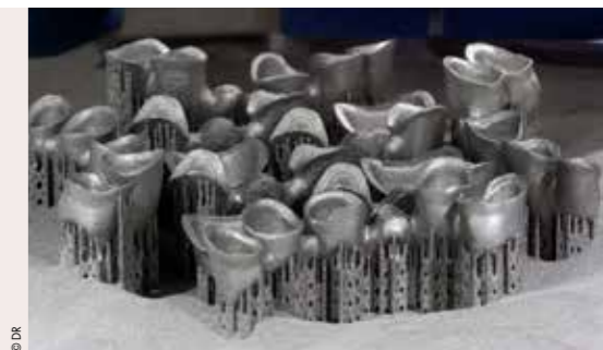
Éléments produits par microfusion laser sélective (image aimablement fournie par Alkom Digital).
