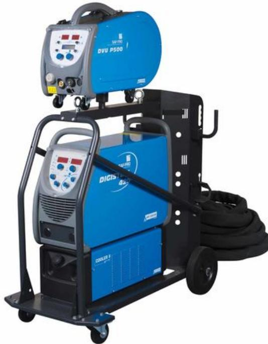
Le **soudage MIG-MAG** (respectivement **Metal Inert Gas** et **Metal Activ Gas**), est un procédé de soudage semi-automatique. La fusion des métaux est obtenue par l'énergie calorifique dégagée par un arc électrique qui éclate dans une atmosphère de protection entre un fil électrode fusible et les pièces à assembler.
